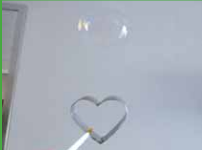
Imagen 1. Burbuja esférica a partir de un molde con forma de corazón
