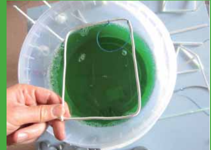
Imagen 3. Círculo generado al trasladar el nudo de la cuerda sobre el perímetro metálico. La película de jabón minimiza el área y se crea un círculo
